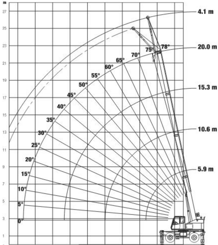
**Характеристики грузоподъемности дополнительной стрелы**
